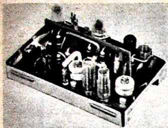
„Transmodul“- Bauteil (UKW- Teil) von Arena UKW-Steuer- gerät „T 2400“ (Arena)
